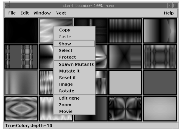
図 4: 個体メニュー。フィールド中の個体の上にマウスカーサを移動し、右ボタンを押すと表示される。指示された個体に対する操作が行なわれる。
